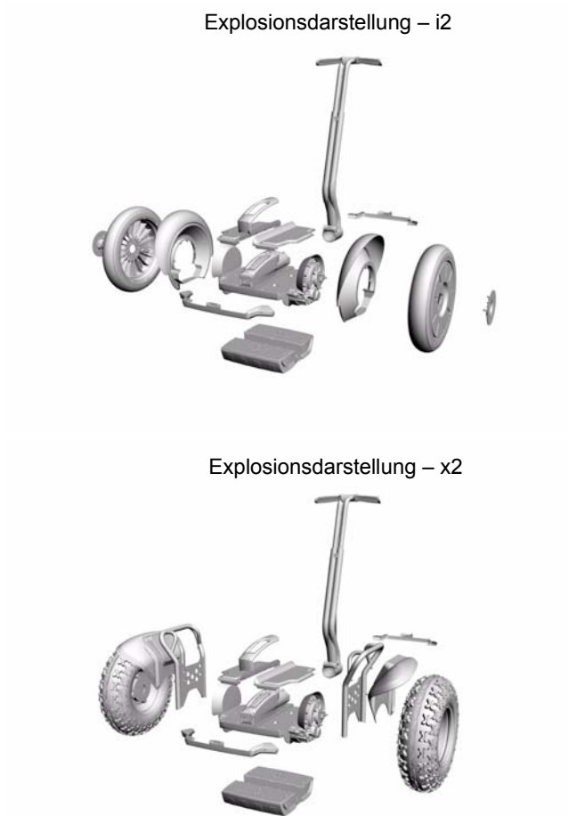
Abbildung 27. Bauteildiagramm für den Segway PT (Modelle i2, x2)
